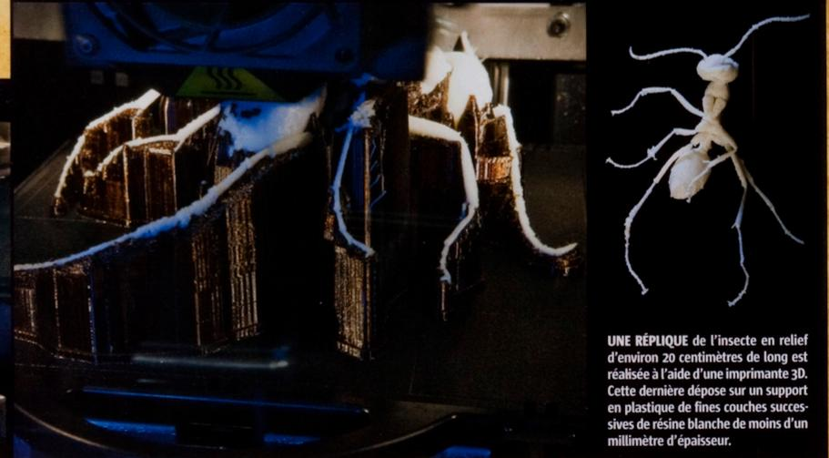
**UNE RÉPLIQUE** de l'insecte en relief d'environ 20 centimètres de long est réalisée à l'aide d'une imprimante 3D. Cette dernière dépose sur un support en plastique de fines couches successives de résine blanche de moins d'un millimètre d'épaisseur.
