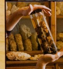
**LES MORCEAUX D'AMBRE** recelant des organismes sont classés et répertoriés (en haut). Avant leur analyse aux rayons X, ils sont placés dans des tubes contenant de l'eau ou du gel. Ainsi, la trajectoire des rayons n'est pas perturbée.
