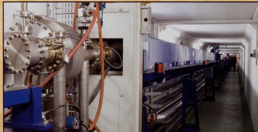
**DANS LE SYNCHROTRON DE L'ESRF**, les électrons produisent des faisceaux de lumière qui alimentent des lignes de lumière, ci-dessus, avant de venir éclairer l'ambre. Pour cela, les électrons circulent dans un anneau de 844 mètres de diamètre, situé dans le bâtiment ci-dessous.
