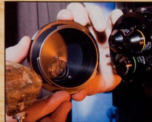
**LE DÉTECTEUR** pour la microtomographie est composé d'un microscope optique, à droite, avec ses objectifs, sur lequel vient se superposer un scintillateur (à gauche) qui convertit les rayons X du synchrotron en lumière visible.
