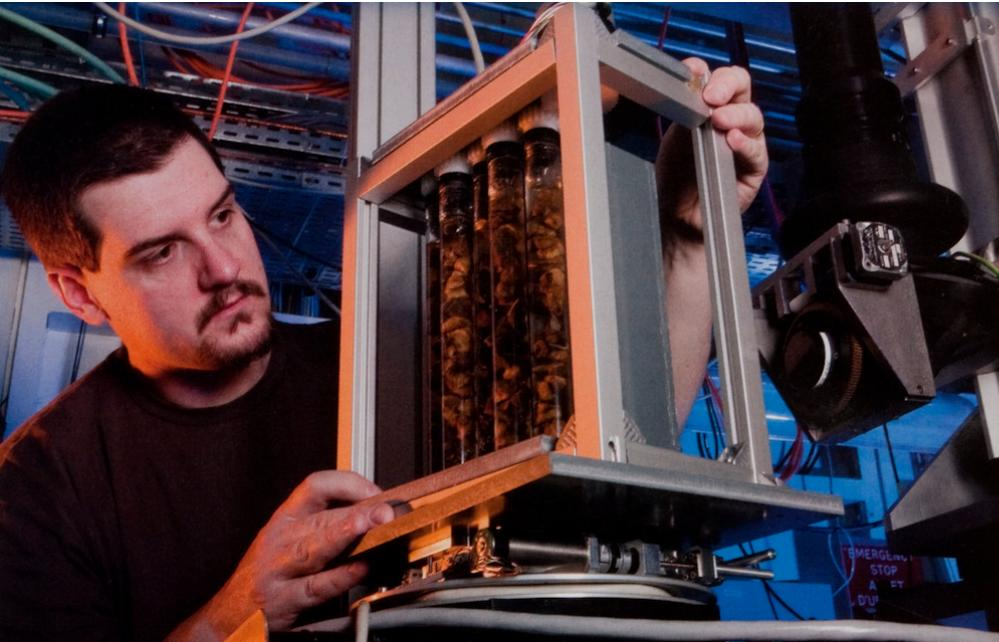
**CE PALÉONTOLOGUE** place les échantillons d'ambre en face d'un détecteur haute résolution afin de réaliser une radiographie. Il peut ainsi savoir si les échantillons d'ambre opaque abritent des insectes. Si tel est le cas, l'échantillon est, comme ci-dessous, soumis à la ligne de lumière du synchrotron pour la microtomographie : cette étape permet d'obtenir des images en trois dimensions des insectes.
