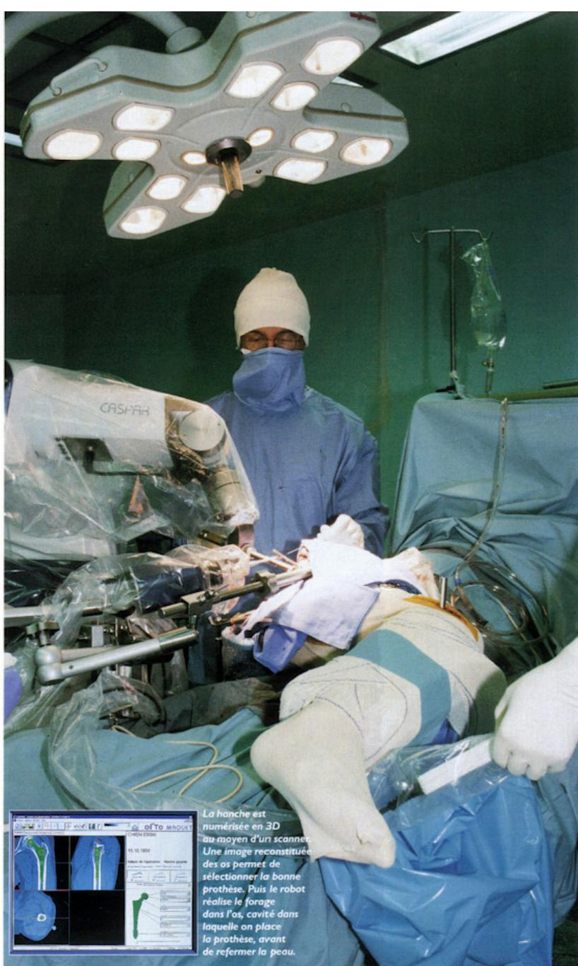
La hanche est numérisée en 3D au moyen d'un scanner. Une image reconstituée des os permet de sélectionner la bonne prothèse. Puis le robot réalise le forage dans l'os, cavité dans laquelle on place la prothèse, avant de refermer la peau.
