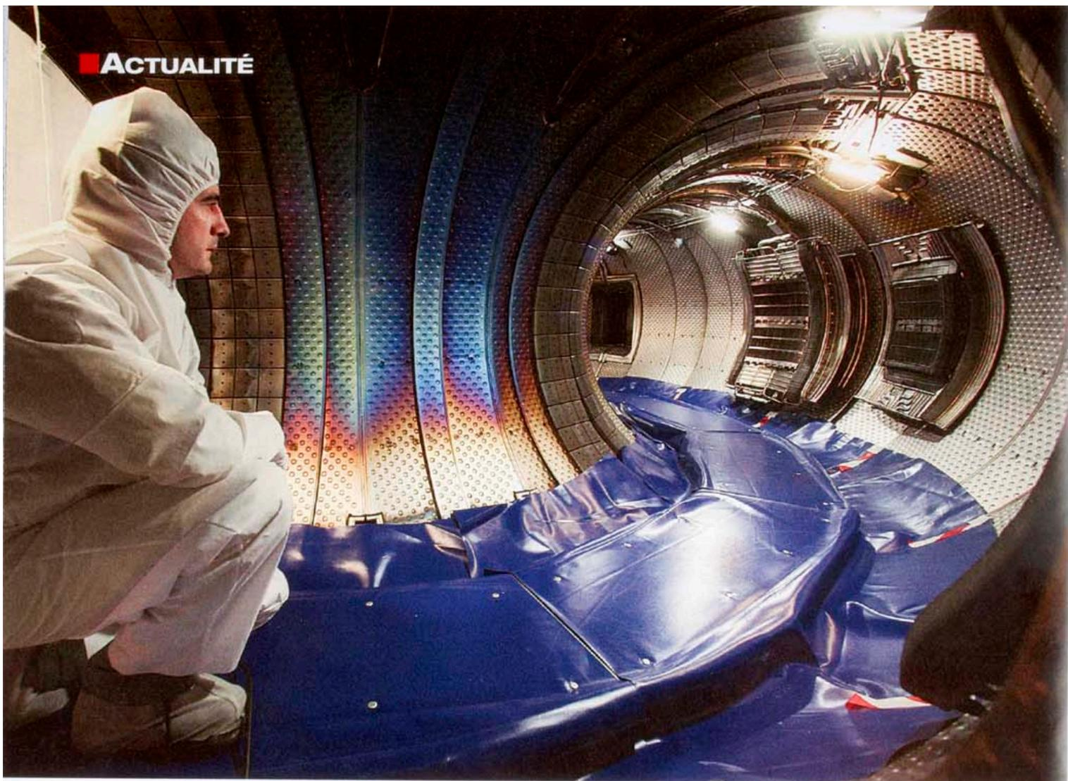
A Cadarache, dans les entrailles de Tore Supra, qui préfigure ce que sera bientôt ITER. Un anneau où le plasma est chauffé à une température de plusieurs dizaines de millions de degrés (plus élevée que celle du centre du Soleil) par les ondes à très haute fréquence émises par les antennes (à droite).
