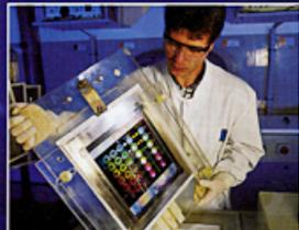
Par électrolyse - l'opération prend plusieurs heures - les images qui se trouvent sur le photo-resist sont transférées sur une plaque de métal souple, appelée matrice.
